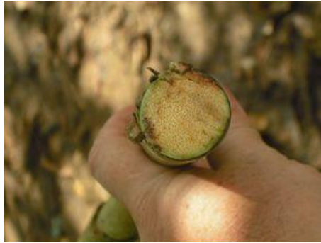
Querschnitt eines Rattan-Stabes: die poröse Struktur des Holzes verleiht dem Rattan die geringe Dichte und besondere Elastizität.
